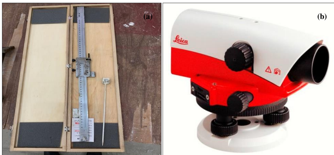
Hình 4. (a) Kim đo mực nước hạ lưu; (b) Máy thủy bình Leica NA.
